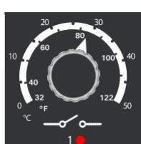
O AC 3-T A integra três termostatos de reserva que funcionam como backup para o controle de temperatura do controlador climático.
